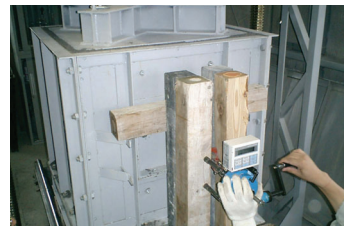
アンカー部材引抜試験状況
